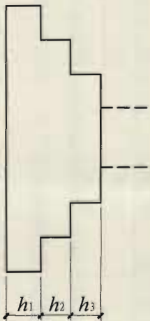
图 2.3.2-1 阶形截面普通独立基础竖向尺寸
