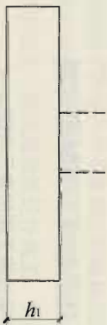
图 2.3.2-2 单阶普通独立基础竖向尺寸
