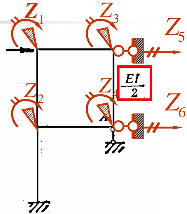
对称轴上的结点A 和B 均有转角和侧移，但无竖向线位移，中央竖杆AB发生挠曲变形。
