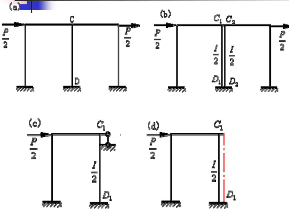
在对称轴上，柱 *CD* 没有轴力和轴向位移，但有弯矩和弯曲变形。可将中间柱分成两根柱，分柱的抗弯刚度为原柱的一半。
