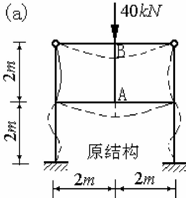
$AB$  杆不会弯曲而只受轴力。不计轴向变形影响，故将  $AB$  杆看作轴向刚度无限的链杆，则  $A$ ， $B$  两点的竖向位移相同。
