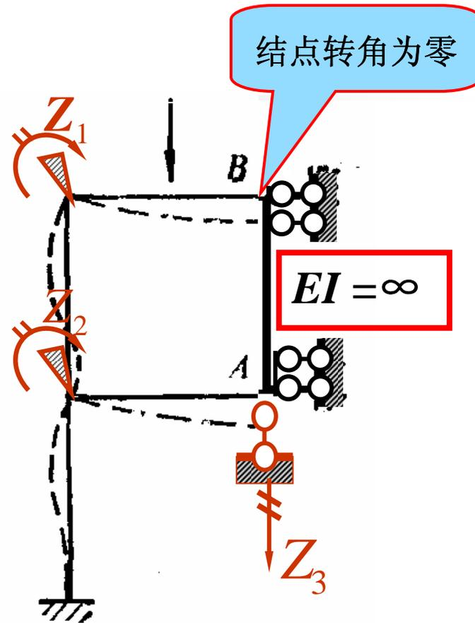
在对称轴上的结点 **B** 和 **A** 均无转角及水平线位移，但可发生竖向线位移且两点相等，中央竖杆 **AB** 不发生挠曲。
