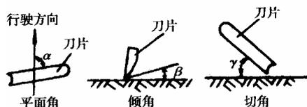
图 6.3.6 平地机刀片安装示意图
