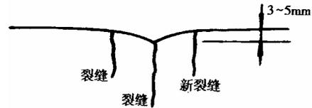
附图 3.1.3 唧浆造成裂缝处沉降示意图
