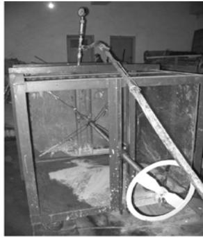
图 1 注浆试验装置
